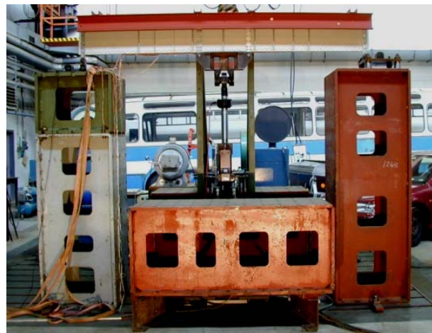
Obr. 6 Únavová zkouška nosníku křídla
