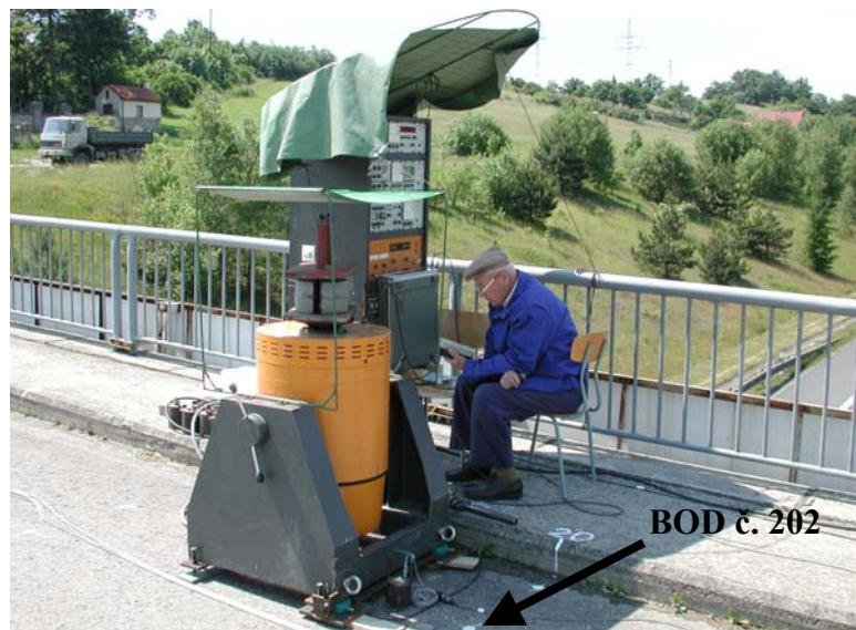
Obr. 4 Elektrodynamickej budič TIRAVIB 5140 a jeho umístění na mostovce.
