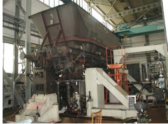
Fig. 2 Wagon shaker rig
