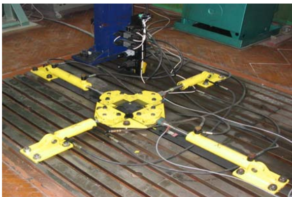
Obr.3 Hydraulické zaťažovacie zariadenie
