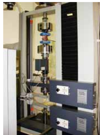
Obr.7 - Zkušební vzorek v Zwick ZO20
