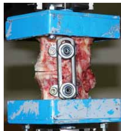
Obr.10 – Porušený páteřní prvek s implantátem MACS
