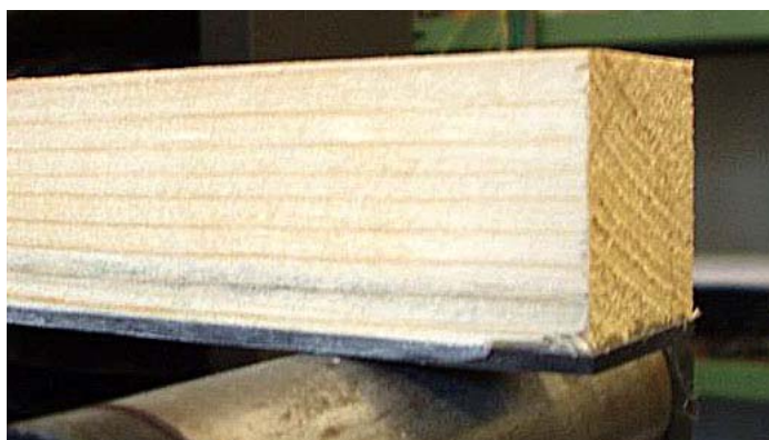
Obr. 1 - Rostlé dřevo s výztuhou na straně dolních vláken
