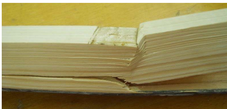
Obr. 4 – Porušení vyztuženého vzorku dřeva
