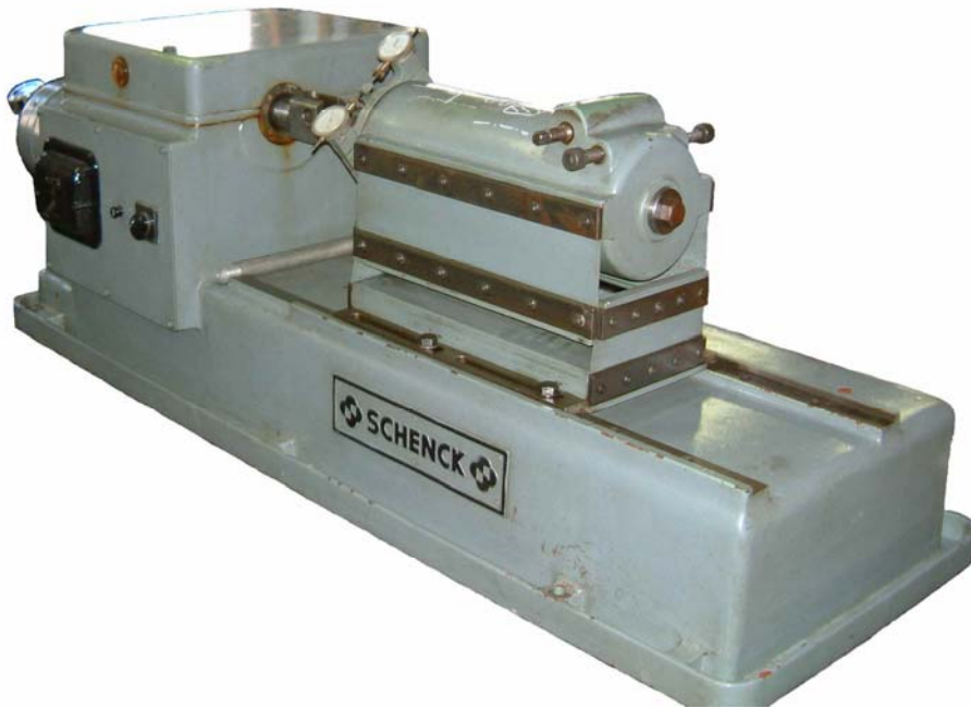
Obr. 1 Zkušební stroj SCHENCK PWXN před rekonstrukcí
