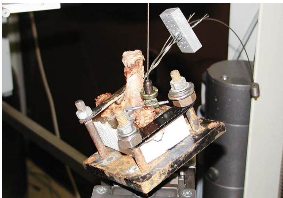
Obr.9 Upnutí vzorku do zkušebního stroje
