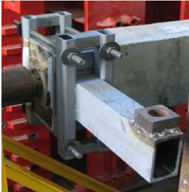
Obr. 3, 4 Zatěžovací rameno, sestavený zatěžovací stand
