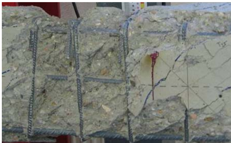
Obr. 6, 7 Oblast porušení nosníku s detailem na rozevřený třmínek
