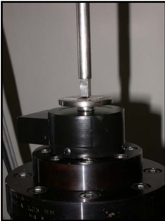
Obr. 7: Přípravek pro určení Poissonova čísla
