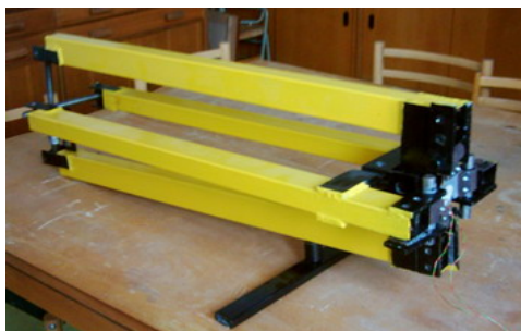
Obr. 3 Zaťažovacie zariadenia pre experimentálnu kalibráciu pri rovinnej napätosti
