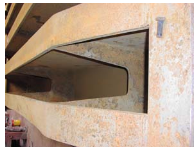
Obr.2 Deformovaná pásnica hradidlovej tabule
