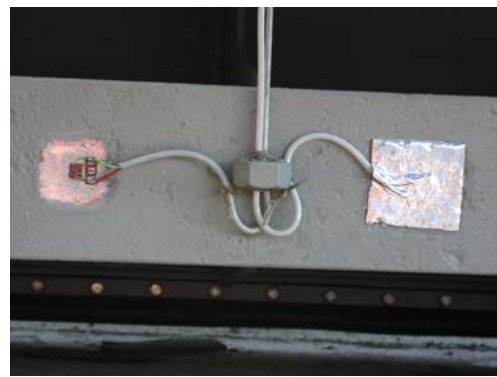
Obr.13 Tenzometrické snímače na siedmom rebre pred zaizolovaním snímačov a po zaizolovaní snímača č.4
