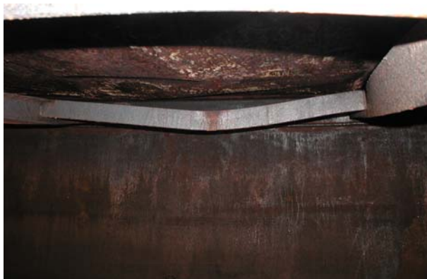
Obr.6 Plasticky zdeformovaný prút polygonálneho prstenca
