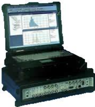
Obr.5 Merací systém PULSE 6 – typ 3560C spolu s ovládacím počítačom
