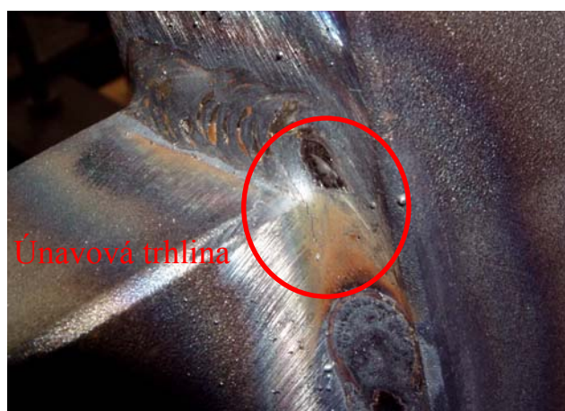
Obr. 8 Iniclace povrchové trhliny
