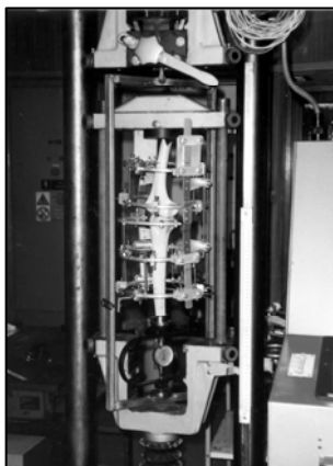
Obr. 2 Princip měření na zevním fixátoru MCD
