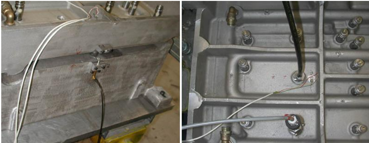
Obr.3 Dělicí rovina se snímačem posuvu a víko formy s přívodem vzduchu, čidlem tlaku a zaslepenými odvzdušňovacími ventily
