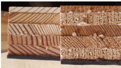
Obr.2 Lepené lamelové dřevo vyztužené uhlíkovou lamelou
