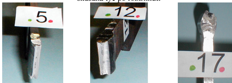
Obr.4 Pohľad na tyče 5, 12 a 17 s neopracovaným zvarom po ich únavovom porušení
