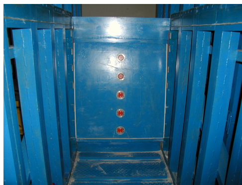
Obr.2 Pohled na pohyblivou čelní stěnu zevnitř, z prostoru zkoušeného zrnitého tělesa, a na rozmístění pěti dvousložkových snímačů tlaku ve stěně
