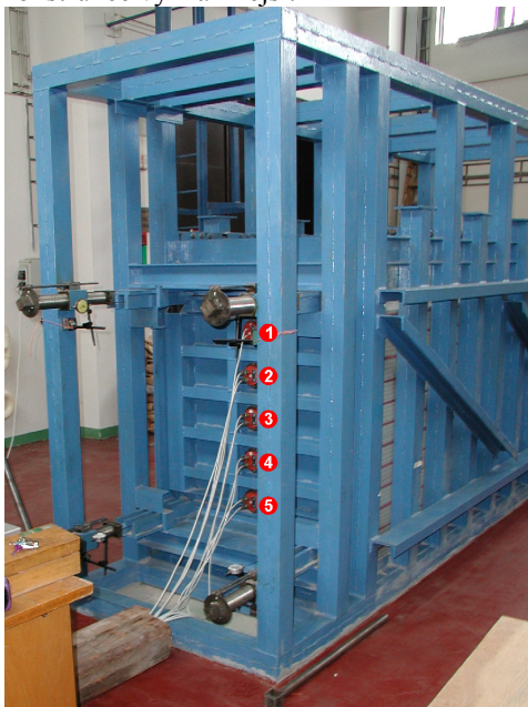
Obr.1 Pohled na přední část experimentálního zařízení s pohyblivou čelní stěnou, ve které jsou osazeny dvousložkové snímače tlaku (s bílými přívodními kabely). Dobře viditelné jsou čtyři hlavní pohybové šrouby zcela vpředu
