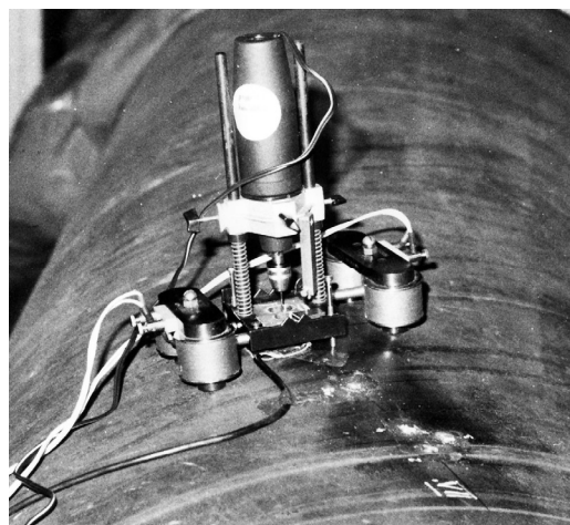
Obr.2 Přípravek SVÚM a.s. k měření pnutí odvrtáváním
