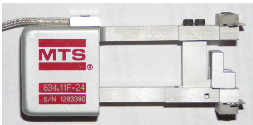
Obr.1 Příložný tenzometrický snímač deformace s odměrnou délkou 25 mm
