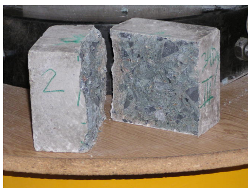
Obr.1 Betonové těleso po zkoušce v příčném tahu
