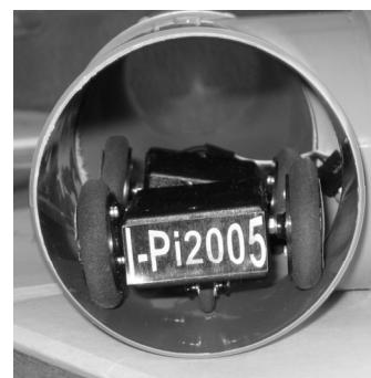
Obr.5 Potrubný stroj I-Pi2005 v potrubí
