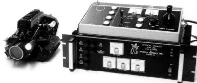
Obr.9 Pásový potrubný stroj VersaTrax Vertical Crawler s celým zariadením
