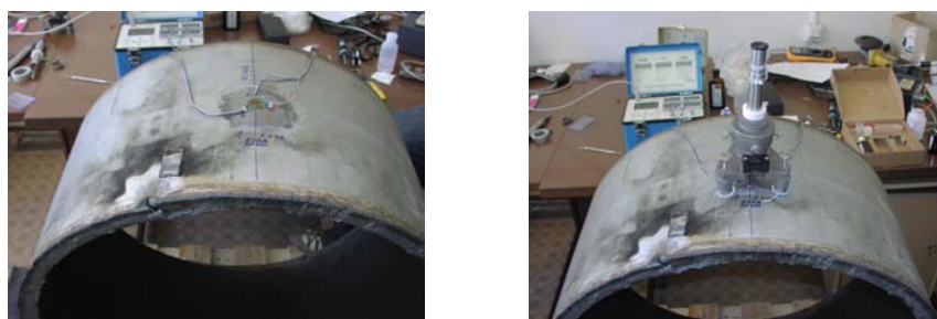
Obr. 20. Objekt merania zvyškových napätí
