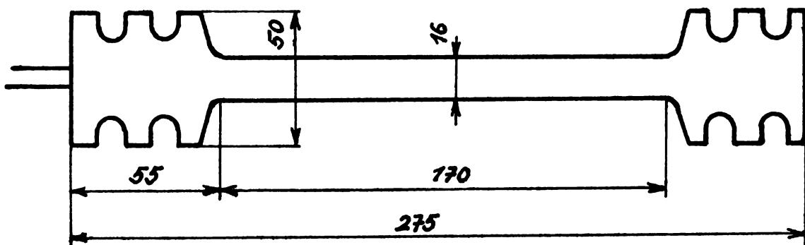
Obr. 1 Rozmery tenzometra TENZOBET-HYDRO. h=1,2
