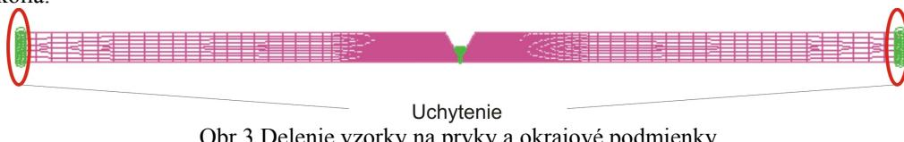
Obr.3 Delenie vzorky na prvky a okrajové podmienky
