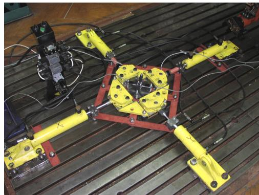
Obr.7 Celkový pohľad na experimentálne pracovisko pri krížovej skúške
