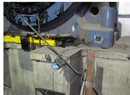
Obr.2 Uchytenie inkrementálnych snímačov MSL 30 a ich poloha pri meraní
