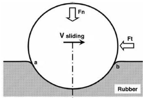
Fig. 5 Ball-plane contact
