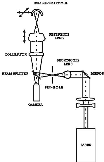
Fig. 11. The scheme of sphereinterferometer.
