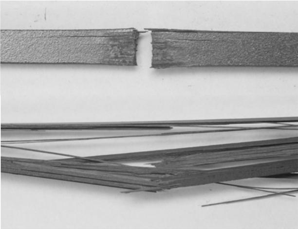
Fig. 7. Fibre failure
