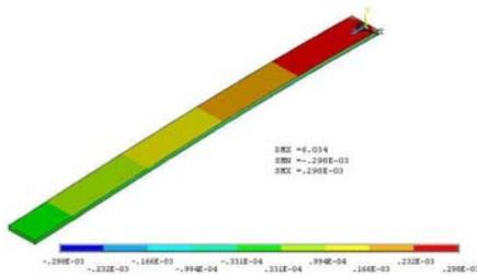
Fig. 12. Cantilever longitudinal strain.
