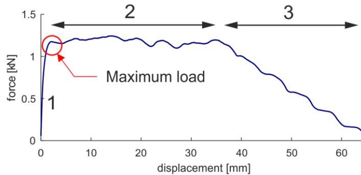
Fig. 4 Measured data (pullout force - displacement)
