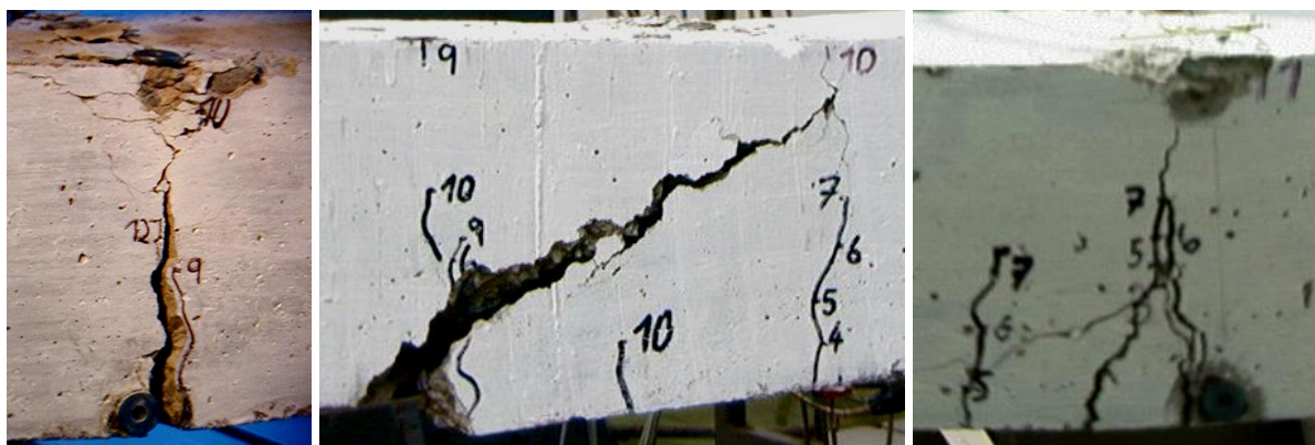
Obr.3 Dosažení únavové životnosti trámů - trám č. 1 (vlevo), trám č. 2 (uprostřed) a trám č. 3 (vpravo). Řez č. 10 je ve středu rozpětí nosníku.
